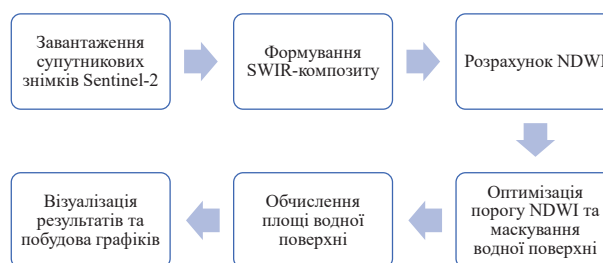
Рис. 4. Блок-схема методики дослідження динаміки водної поверхні озера Солонець-Тузли, за супутниковими даними Sentinel-2
