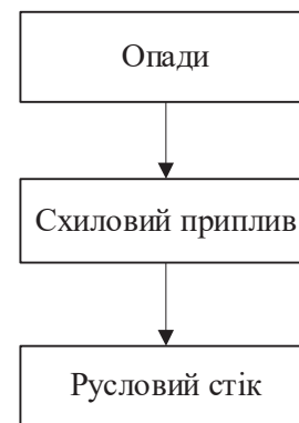
Рис. 1. Схема формування поверхневого стоку (у вигляді трьох блоків)
