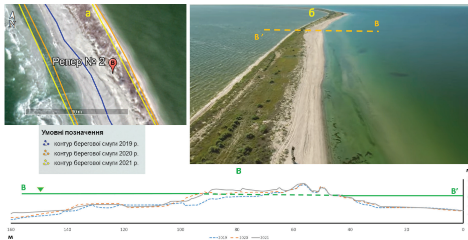
Рис. 3. Динамічні тенденції в береговій зоні дистальної частини Кінбурнської коси. Буквами позначені: а – розташування реперу № 2 та динаміка берегової смуги упродовж 2019–2021 рр.; б – напрямок закладання багаторічного морфодинамічного профілю (В – В') (фото В. Бровко); в – морфодинамічний профіль.
