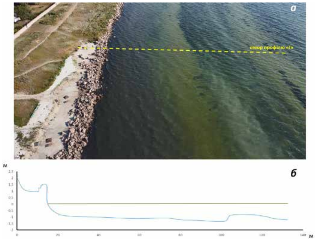
Рис. 13. Профіль «І» берегової зони Утлюцького лиману в межах берегової повздожньої кам'яної накидки біля Генічеського маяка: а – просторове розташування; б – геоморфологічний профіль (фото О. Давидова)
