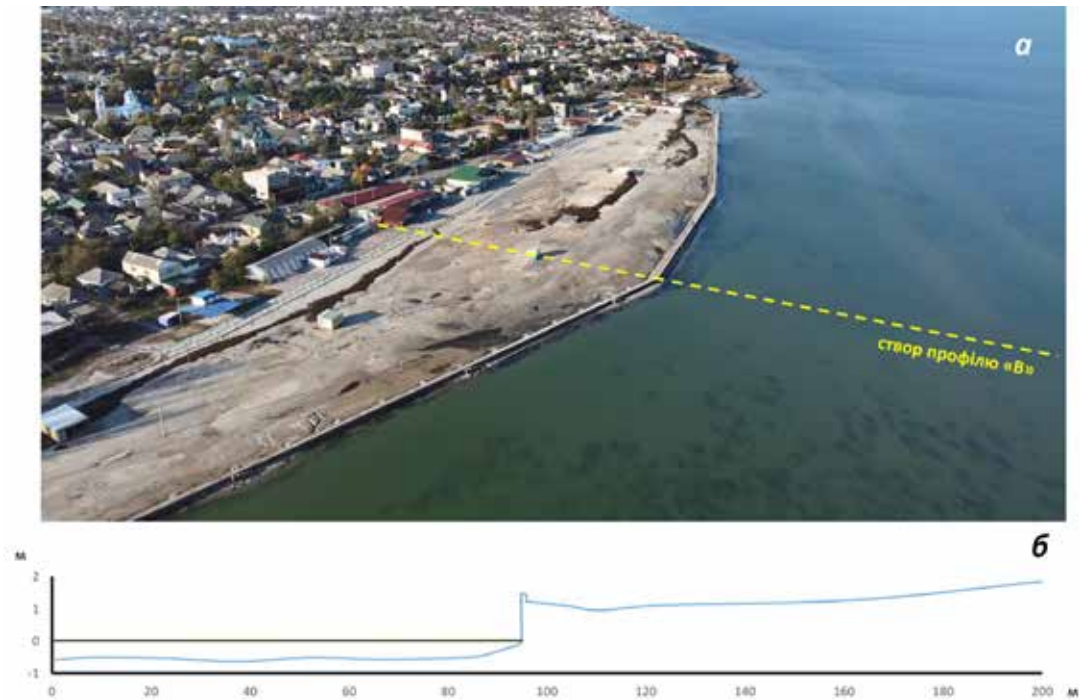
Рис. 6. Профіль «В» берегової зони Утлюцького лиману в межах центральної частини «Міського пляжу»: а – просторове розташування; б – геоморфологічний профіль (фото О. Давидова)
