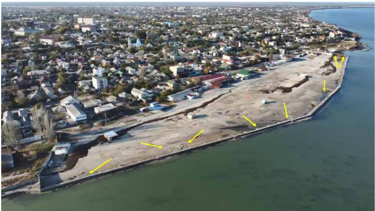
Рис. 3. «Міський пляж», або штучна піщано-черепашкова тераса (жовті стрілки – напрямки руху стокових нагонів вод)
