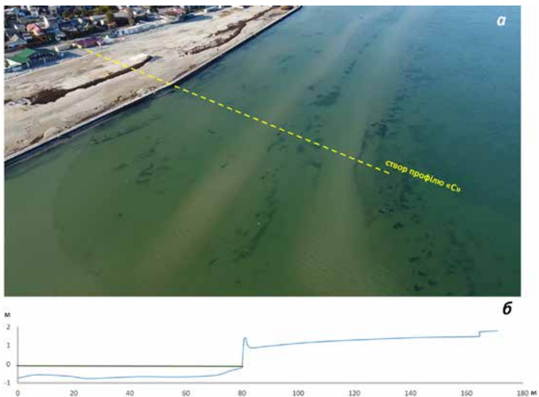
Рис. 7. Профіль «С» берегової зони Утлюцького лиману в межах центральної частини «Міського пляжу» в районі другого кута бетонного парапету: а – просторове розташування; б – геоморфологічний профіль (фото О. Давидова)
