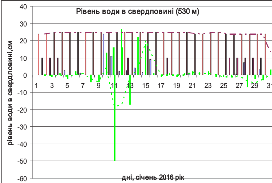
Рис. 3. Зв'язок рівня води в глибокій свердловині (штрих-пунктирна лінія) (глибиною 530 м) із рівнями води в річці Тисі (діаграма чорного кольору), сучасними рухами (штрих-лінія зеленого кольору) та місцевою сейсмічністю в січні 2016 року (діаграма червоного кольору)
