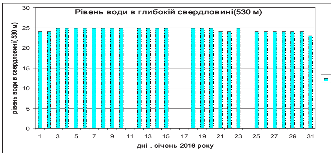
Рис. 1. Рівень води в свердловині глибиною 530 м. РГС «Тросник», січень 2016 року
