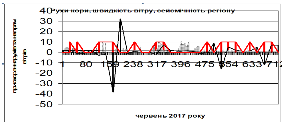
Рис. 8. Сучасні рухи кори (крива чорного кольору) та сейсмічність (діаграма червоного кольору), швидкість вітру (діаграма сірого кольору) в червні 2017 року на РГС «Тросник» та ПДС «Королево»
